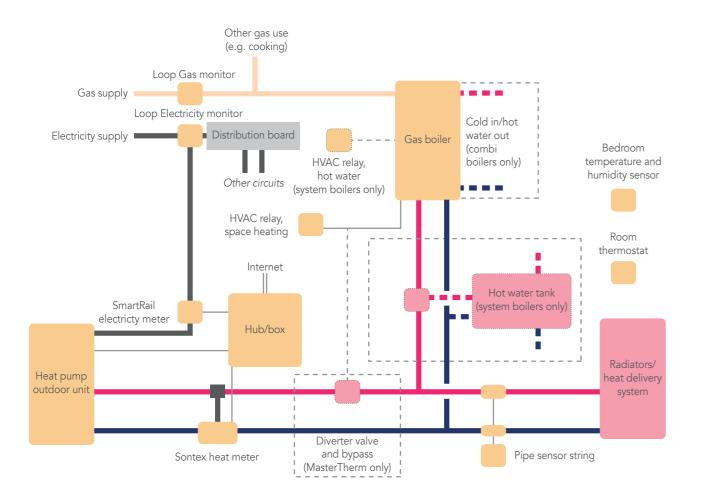
Figure 16. Meter schematic
